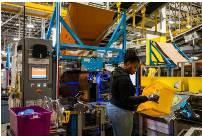
Fot. Pracownik na stanowisku pakowania, gdzie przedmioty są umieszczane w metalowej szczęcie, a wokół nich formowane jest opakowanie papierowe.
